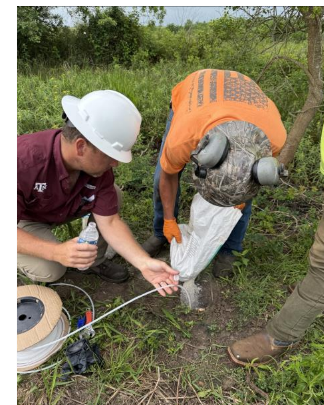
Instalación de sondas de gas del suelo (verano de 2025)
